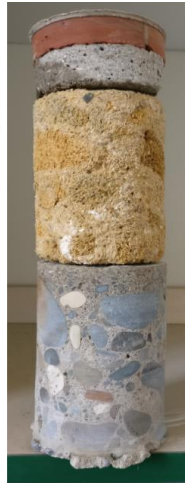
Εικόνα 43. Πυρήνας C1 - παράθεση από την ρηχή κοιλότητα (2ης). Παρουσιάζει μεγάλη συμπαγροποιήση υλικών που δεν αντιστέκεται σε μικρή πηγή ή προηγούμενη αντοχής.
