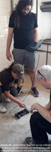
Εικόνα 40. Χρήση Rebar Detector για την εύρεση της θέσης της αρμολογίας της δομής από οπλισμό στα στοιχεία και ανίχνευση ανωδομής.
